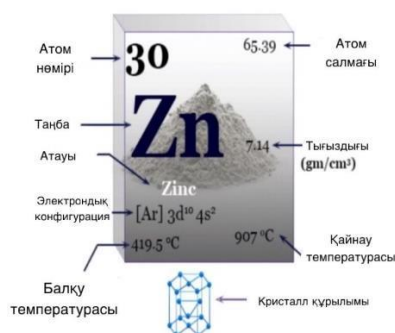
1 сурет - Zn металының құрылымы [2].
