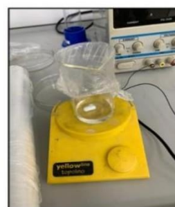
Магнитті араластырғышта 1-3 минут аралығында мөлдір болғанша араластырамыз
